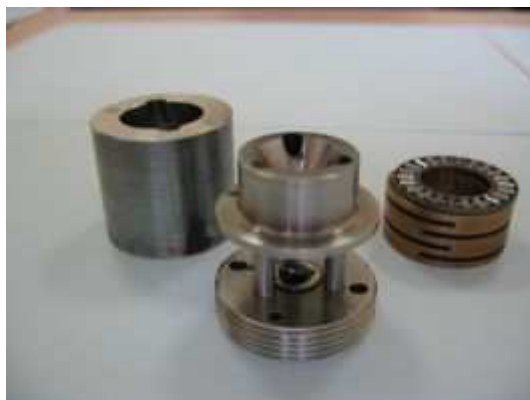
Рисунок 19 - Немагнитная симметричная камера с алмазными наковальнями в эксперименте по измерению транспортных свойств в гелиевом криостате
