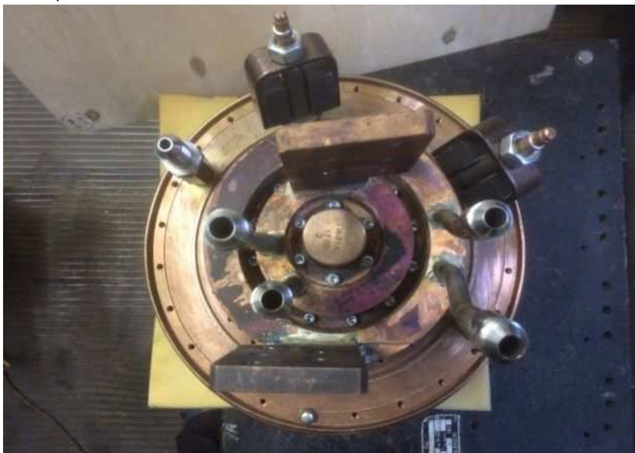
Рисунок 16 - Общий вид лампы ГИ-71А с встроенными вакуумами.
