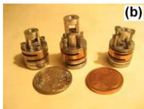
Рисунок 20 - Миниатюрная немагнитная камера с алмазными наковальнями
