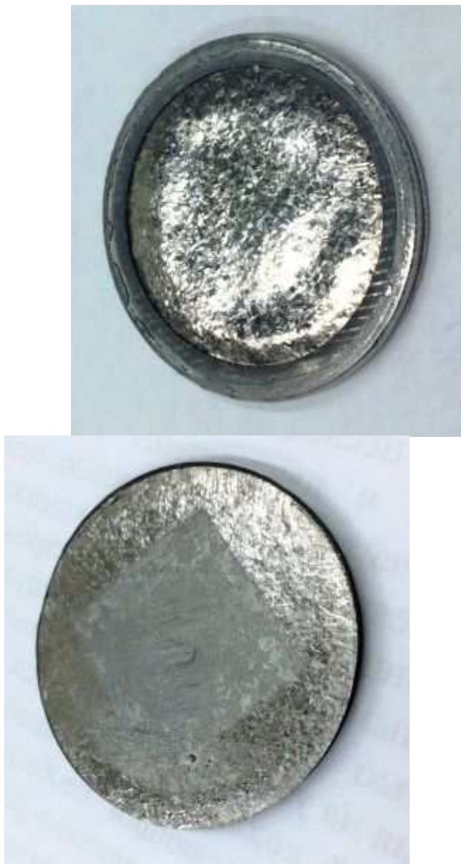
Рисунок 32 - Изготовленные прототипы мишеней в ниобиевой оболочке с рабочим веществом - металлический иттрий: слева - с укрепляющим кольцом, приваренным электронно-лучевой сваркой, без диффузионной сварки; справа – без укрепляющего кольца, но с диффузионной сваркой (пресс из молибдена).
