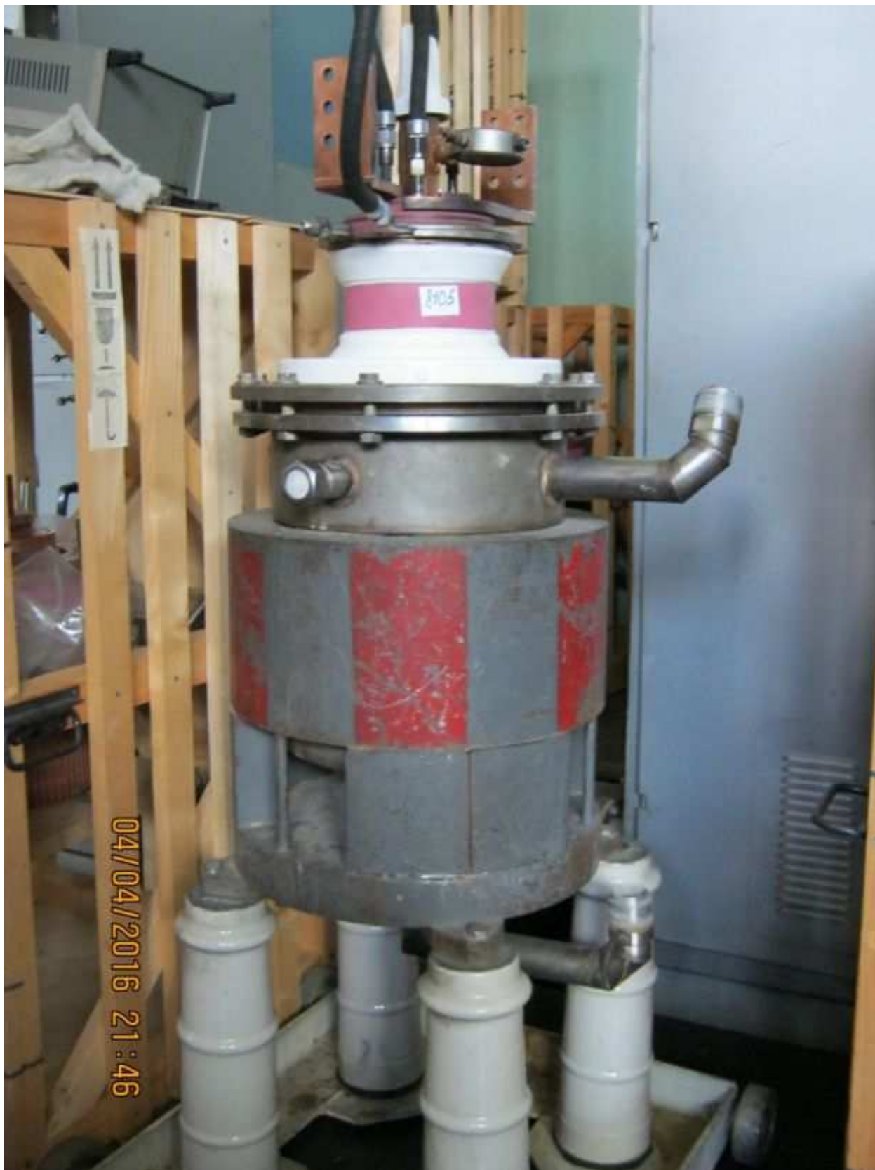
Рисунок 12 - Лампа ГМИ-44А, подготовленная к установке в модулятор
