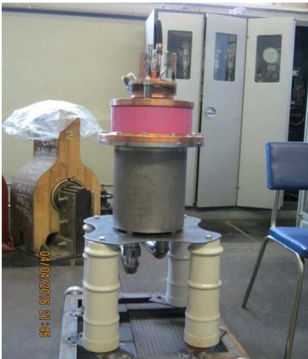
Рисунок 11 - Лампа ГИ-71АМ, подготовленная к установке в модулятор.
