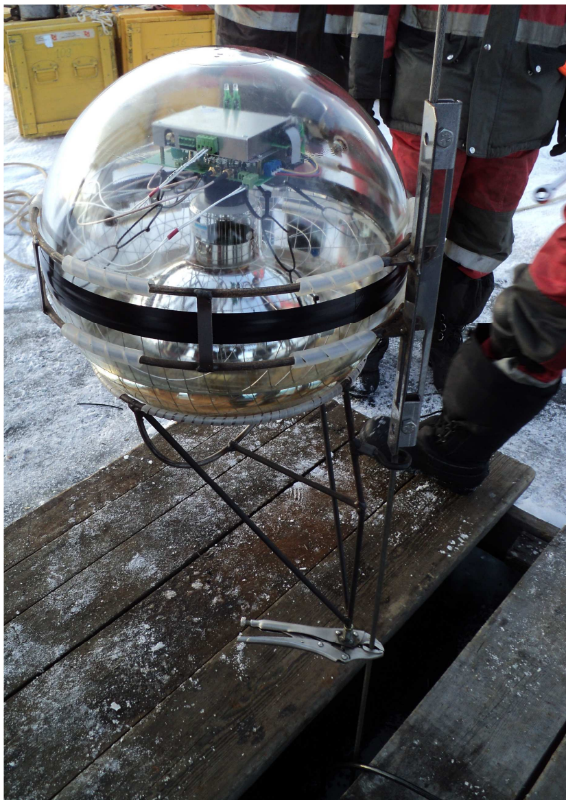
08. Прикрепленный к тросу оптический модуль.
