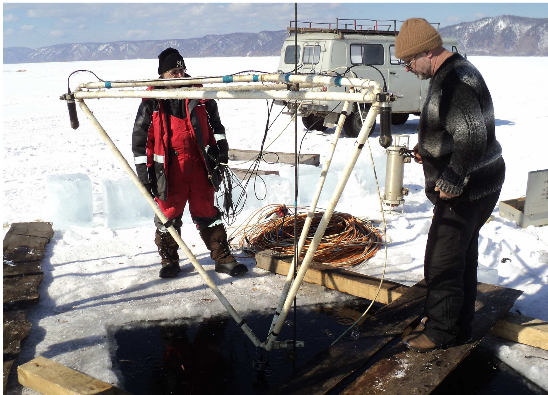
12. Акустическое устройство для изучения возможности регистрации нейтринных событий по акустическим сигналам.
