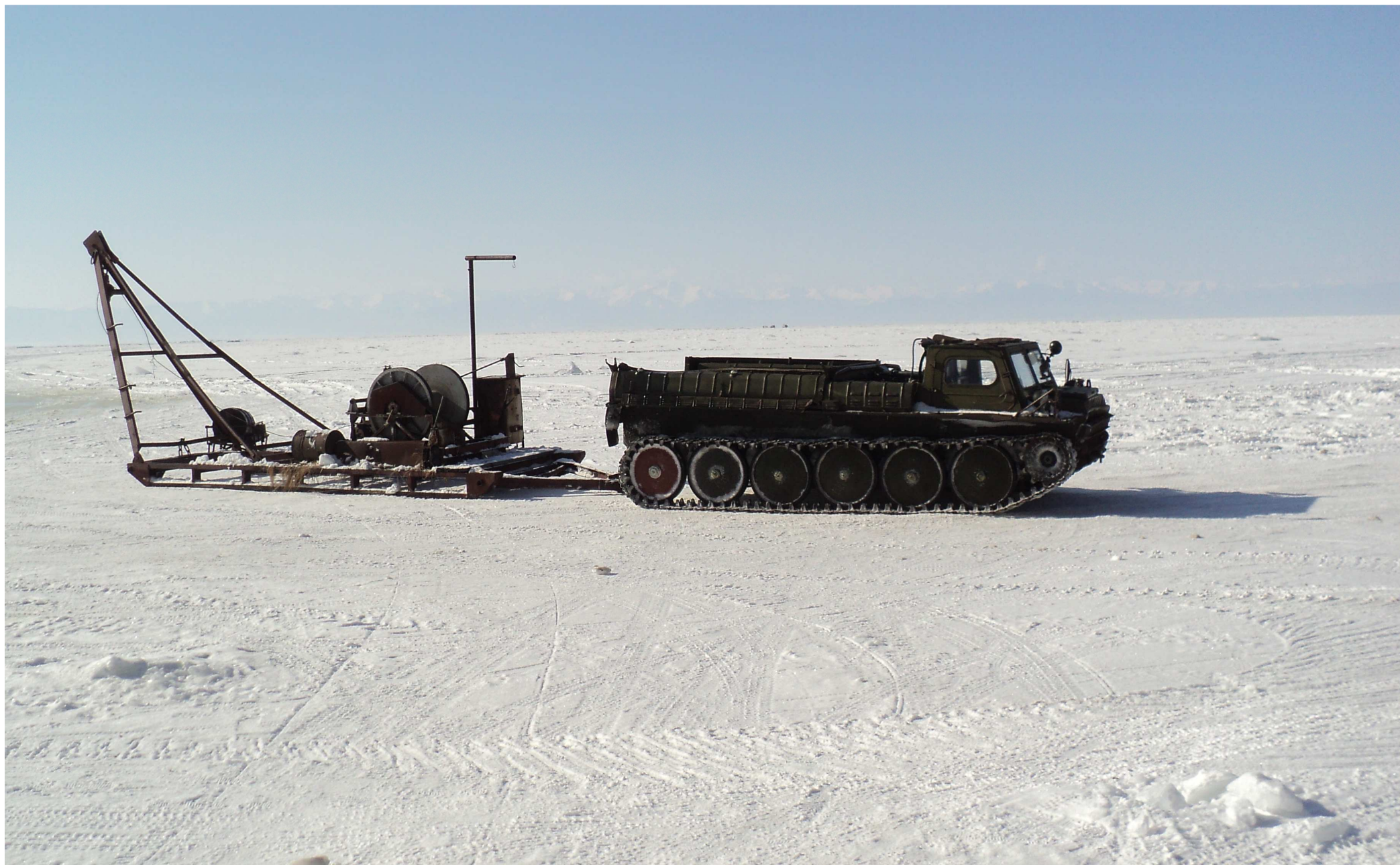
02. Транспортировка лебедок в ледовый лагерь для установки гирлянд ОМ
