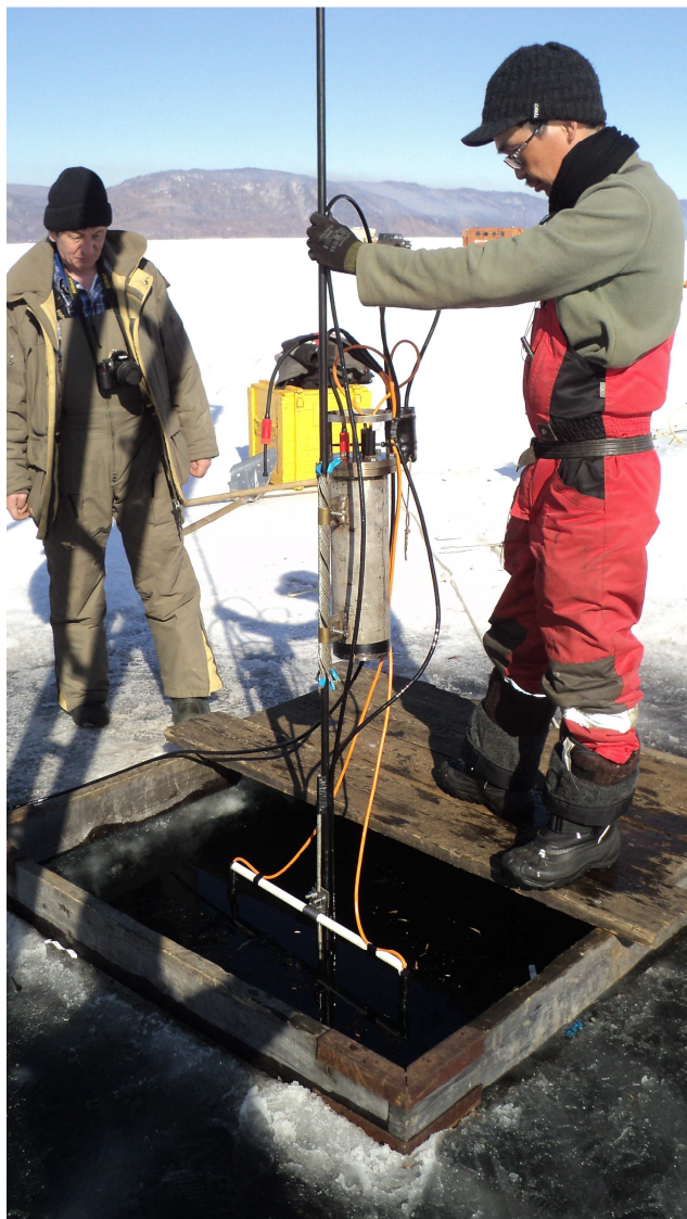
10. Установка в состав гирлянды акустического устройства для определения координат оптических модулей, разработанного НИИПФ Иркутского государственного университета.
