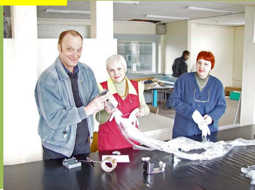
Сборка оптических кабелей в ЦЕРН и вклейка волокон в оптические разъемы
