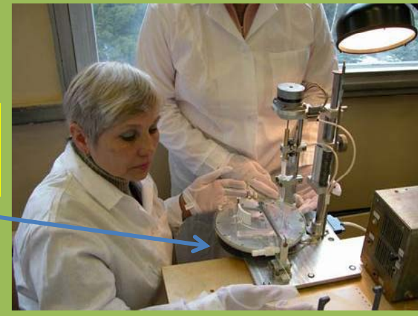
Аппарат для автоматической укладки и вклейки 3.5 витков волокна в ячейку
