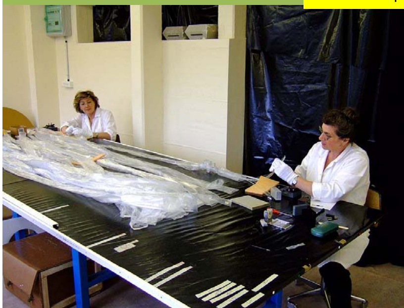
Сборка оптических кабелей в ЦЕРН и вклейка волокон в оптические разъемы
