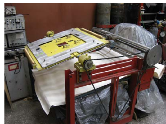
Рис 16. Станок для намотки рам проволокой. На платформе размещается две рамы. Шаг намотки выбирается кратно 1 мм. Максимальная ширина намотки 800 мм
