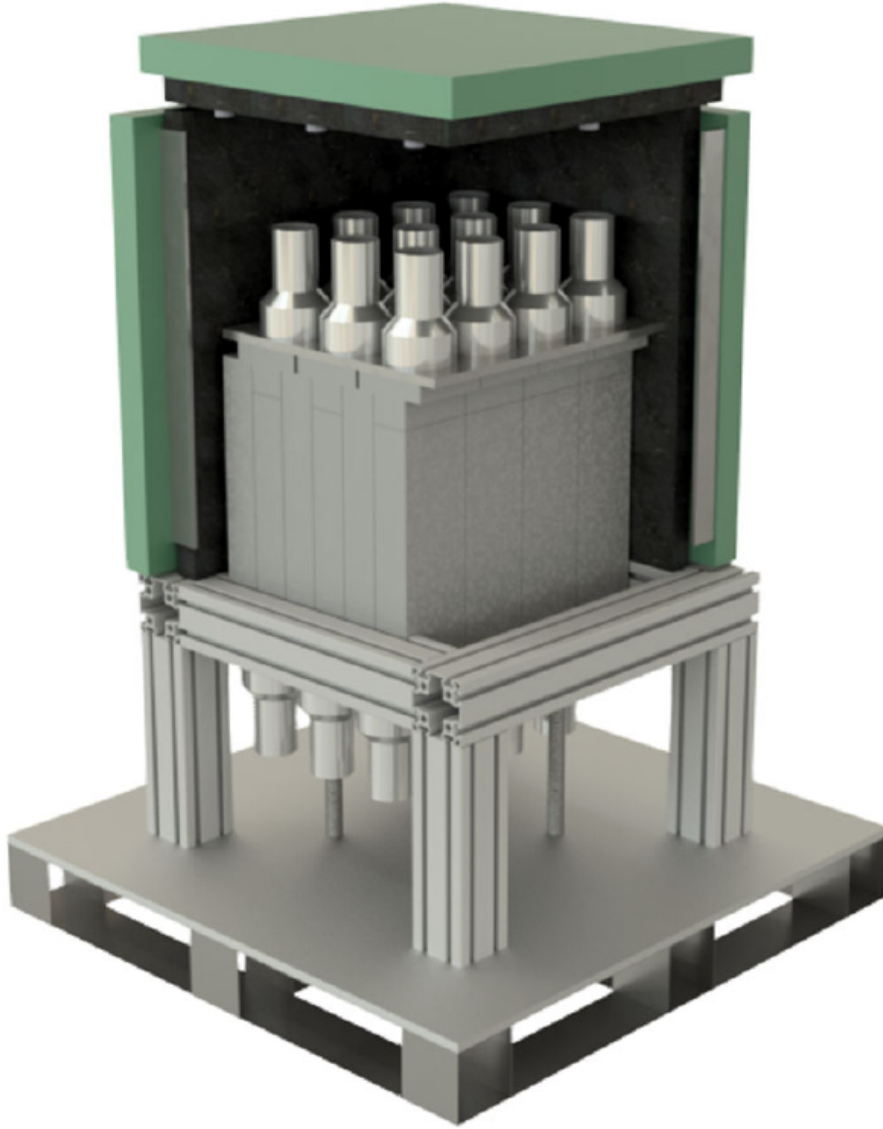
Рисунок 2.12 — Вид в разрезе детектора NaIvE. Зеленым цветом выделены панели мюонной вето-системы [9].
