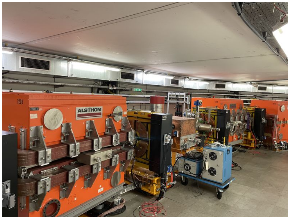
Рисунок 3.4: Предполагаемое место расположения соленоида на ускорителе COSY для реализации ST режима управления поляризацией (между диполями).
