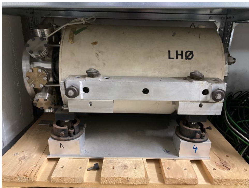
Рисунок 3.3: Соленоид LH0 для реализации ST режима управления поляризацией на ускорителе COSY.
