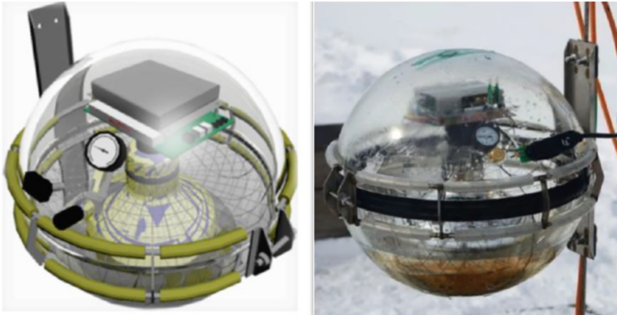
Рис. 1. Модель оптического модуля (слева) и фотография оптического модуля смонтированного на гирлянде (справа)
