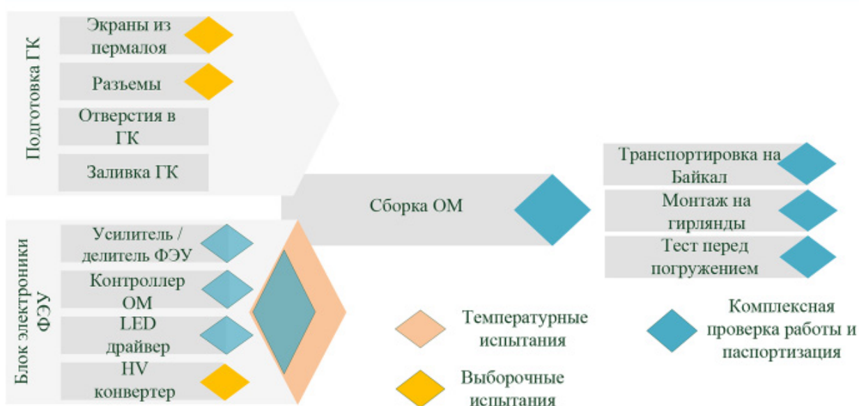
Рис. 3. Схема поэтапной подготовки и испытаний ОМ
